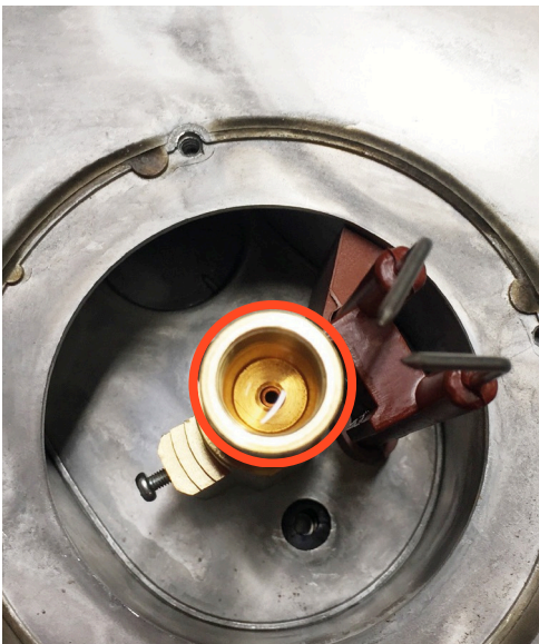
9: Controleer het nozzlehuis op verontreinigingen en reinig deze voordat u de nieuwe nozzle installeert.
